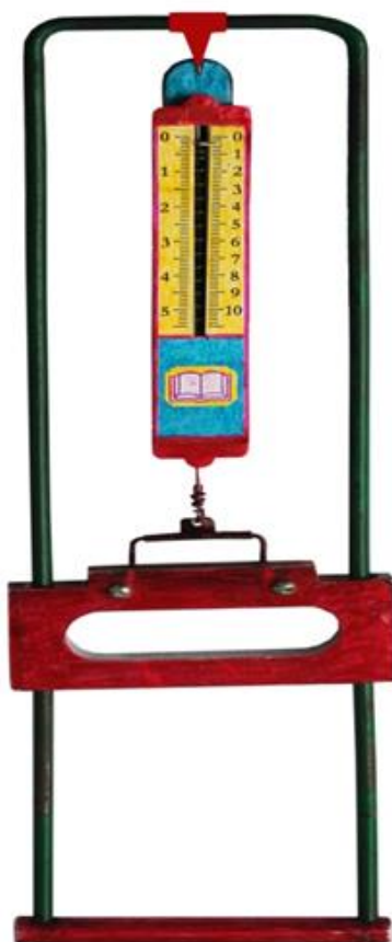
Рис. 1. Экспериментальный образец для определения основных размеров винтообразных цилиндрических пружин
